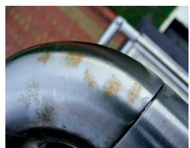
Für ein gutes Aussehen ist es notwendig, das Geländer durch geeignete Behandlung und Reinigungsmittel zu pflegen. Für die erste Reinigung nach der Montage sollte Reinigungsspray für Edelstahl (A/ Cleaner-500ml) verwendet werden. Zur Be- und Verarbeitung von Edelstahl müssen Werkzeuge, Gerüste und Transportmittel verwendet werden, die für Edelstahl ausgelegt sind.
